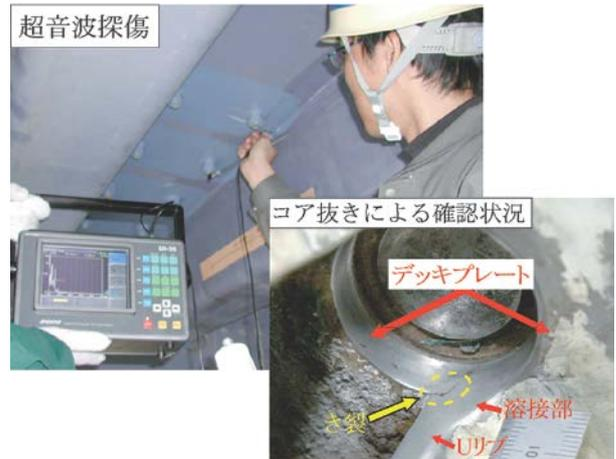
写真-2 従来法による上向きの超音波(手動)探傷による調査状況
