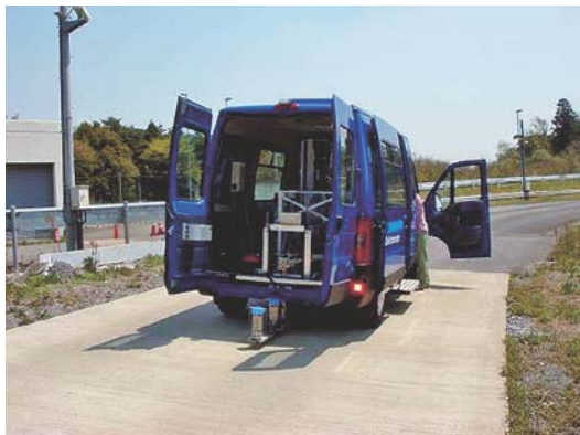
写真-4 FWDの計測状況
