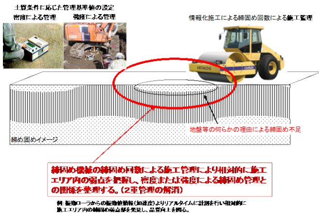
図-1 情報化施工による盛土品質管理
