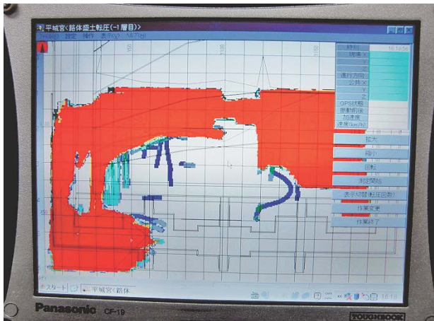
写真-7 転圧締め管理システム表示画面
