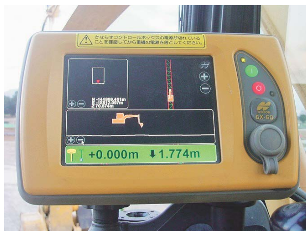
写真-5 3D-MG コントローラ画面
