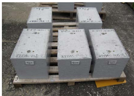
写真-1 暴露予定供試体
