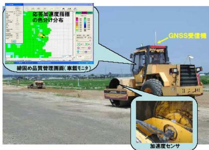
図-5 加速度応答による品質管理
