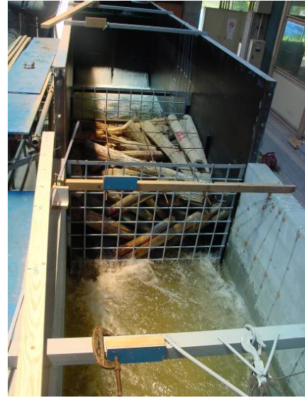
(空隙率0.680、流量500L/s、実験水路下流から撮影)
