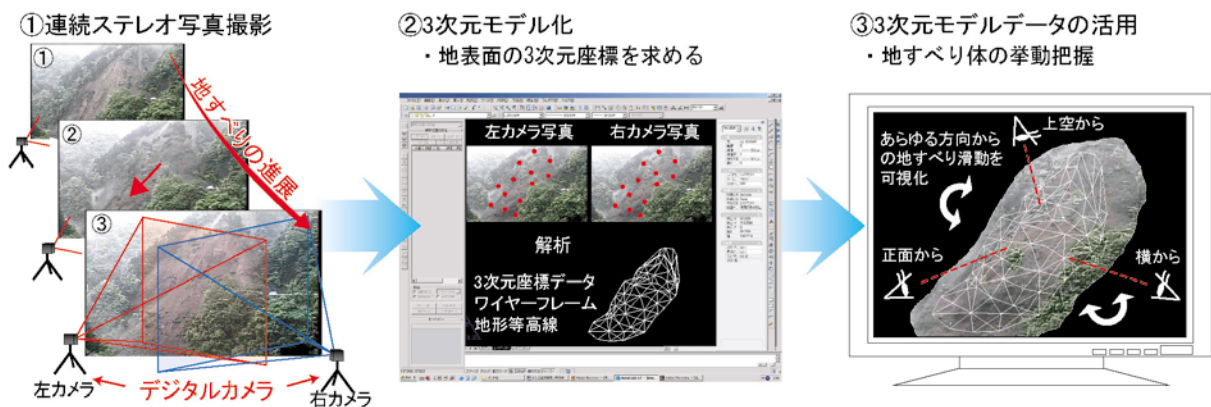
図-1 3次元計測システムの概要
