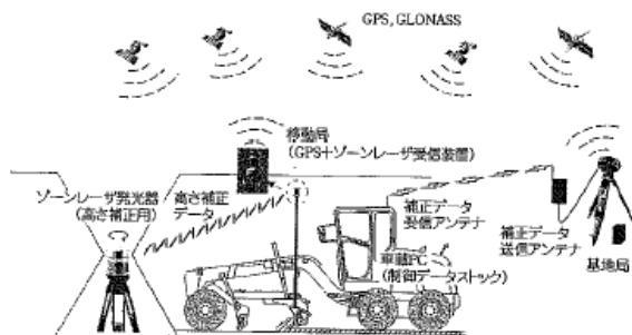
図-3 GPSによるモーターグレーダの自動制御
