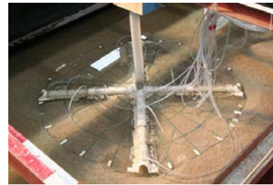
図-4 パイプおよびシートのレイアウト例
