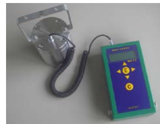
図-3 重錘落下試験機 (内部に加速度計を搭載)
