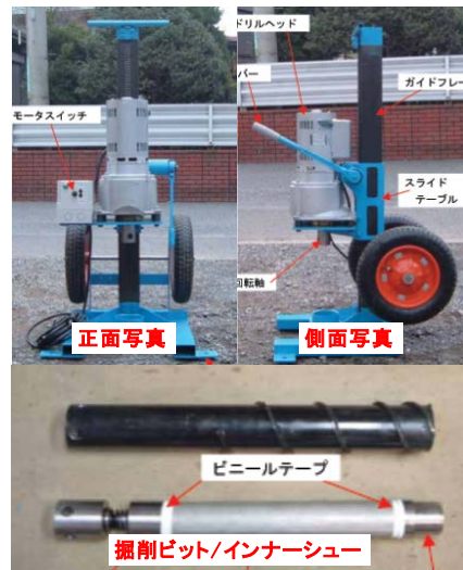
図-2 不攪乱試料採取ボーリング機 (土木研究所にて開発)
