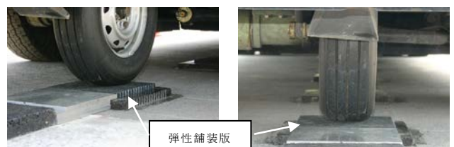
写真-2 試験タイヤ接地状況 (30×30×2cm)
