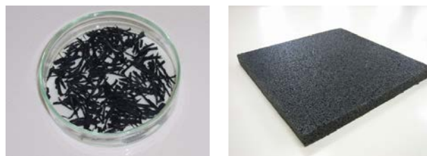
写真-1 歩道用凍結抑制弾性舗装版 (左: ひじき状ゴムチップ、右: 弾性舗装版)
