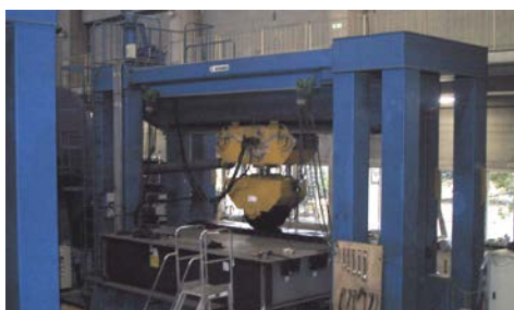
写真-1 鋼床版補強技術に関する輪荷重走行試験
