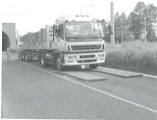
写真-3 動的影響の簡易試験法の例
