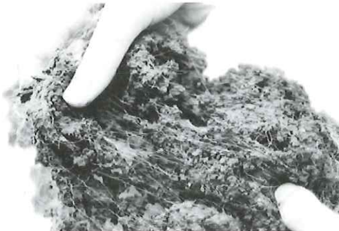
写真-4 短繊維混合補強土工法
