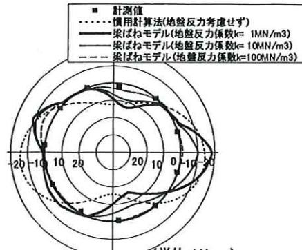
(a) 計測断面  $\alpha$
