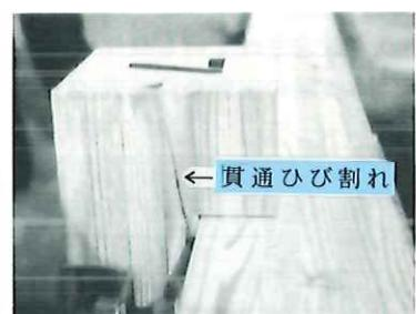
写真-2 嵌合部のひび割れ状況
