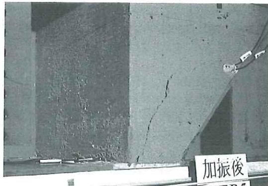
図-10 加振後の供試体 ( $150\text{kN/m}^2$ , 地震波 600gal)
