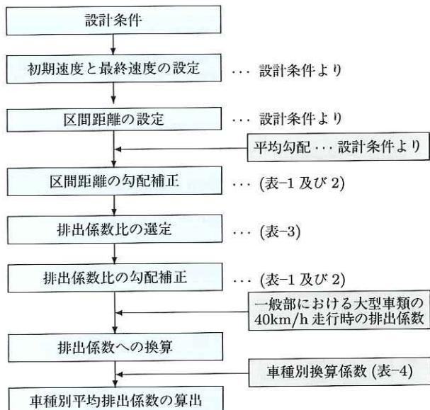
図-2 IC周辺における加減速を考慮した窒素酸化物の排出係数の計算手順
