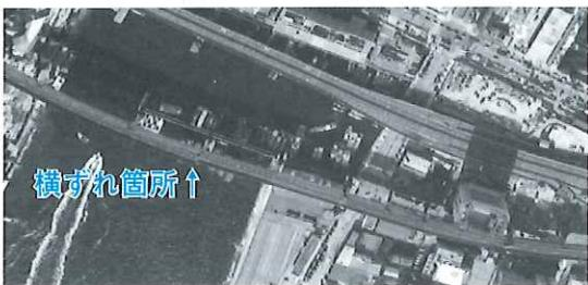
図-3 国道 2 号浜手バイパスの被災状況
