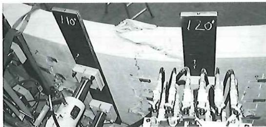
写真-1 供試体の破壊状況 (ケース③: 115度付近)
