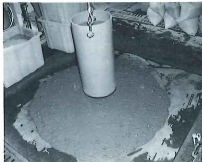
写真-5 大型スランプフロー試験
