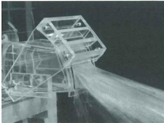
写真-4 引張ラジアルゲート水理模型実験
