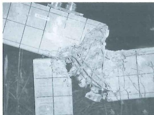
写真-3 主梁載荷点西面 (I-2,H=3.5m)
