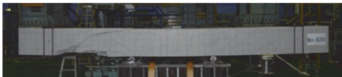
(b)試験後の破壊状況 (定着工法)
