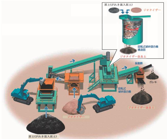
図-2 カルスピン工法の概要
