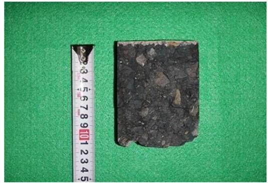
写真-4 暴露1年の塩素（Cl）浸透深さ試験の例
