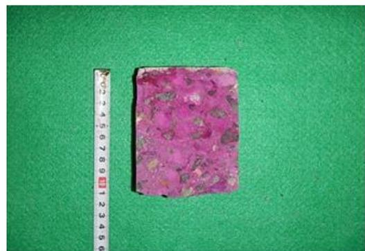
写真-3 暴露1年の中性化試験結果の例
