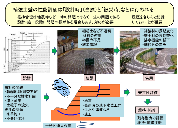
図-7 補強土壁の変状と対策 6)
