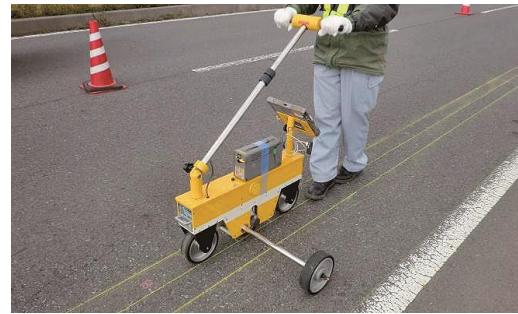
写真-2 小型プロフィールメータ（クラス2）
