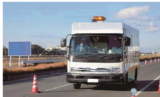
写真-3 路面性状装置（イメージ写真、クラス2）
