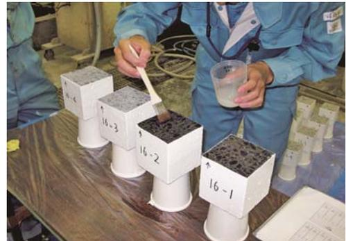
図-2 浸透材塗布状況
