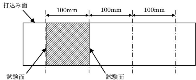
図-1 コンクリートの切断方法
