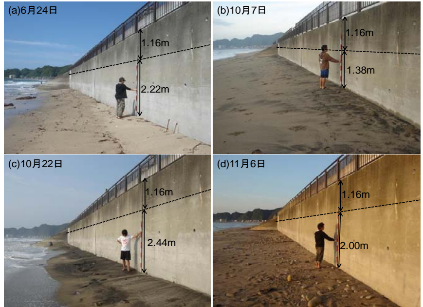
写真-2 測線No.4における2008年6月24日、10月7日、10月22日および11月6日の海浜状況
