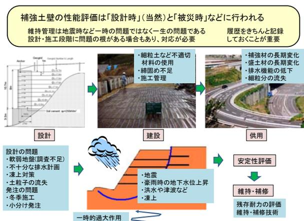
図-1 補強土壁の変状と対策<sup>5)</sup>
