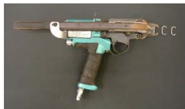
写真-5.2 Cリング及び 専用の 打設銃(Cリンガー : MC-6C )
