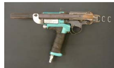
写真-5.2 Cリング及び打設銃(Cリンガー)
