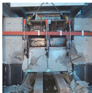
写真-4 鉄筋による吊り下げ状況
