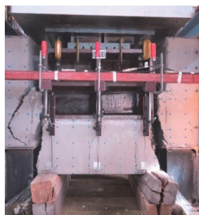
写真-5 鋼繊維補強コンクリートの落下状況
