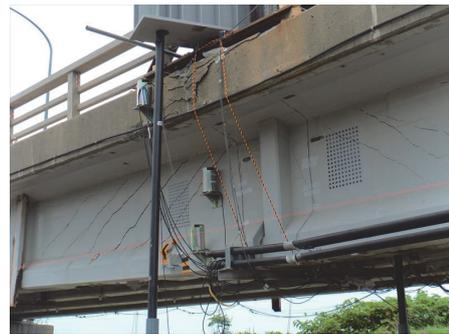
写真-4 載荷点付近 (最大耐力時)
