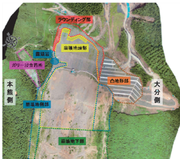
図-4 阿蘇大橋地区崩壊斜面の対策エリア
