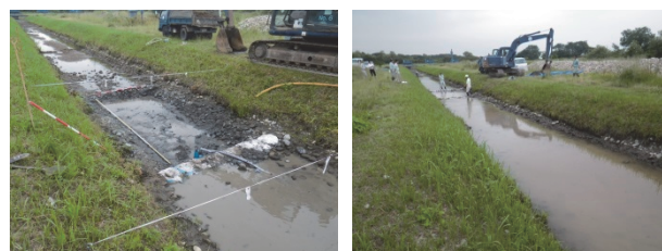
図-4 共生センターの実験河川における底泥の掃流外力に関する操作実験
