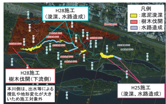
図-6 保全対策の実施状況(大浦地区)
