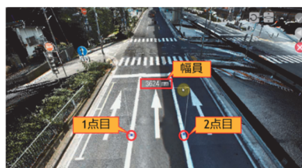
図-4 3D寸法計測（道路幅員）
