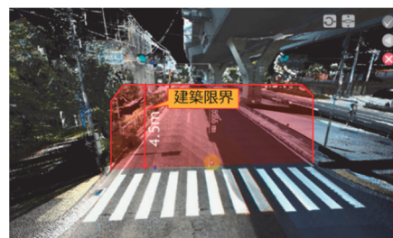
図-5 道路建築限界の確認
