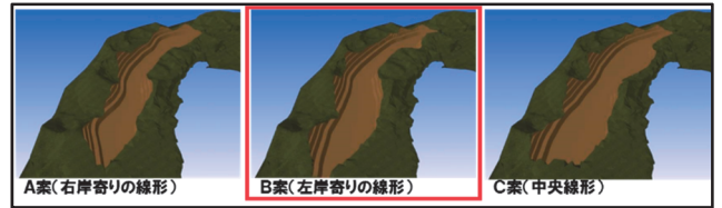
図-2 CGを用いた分水路線形の検討
