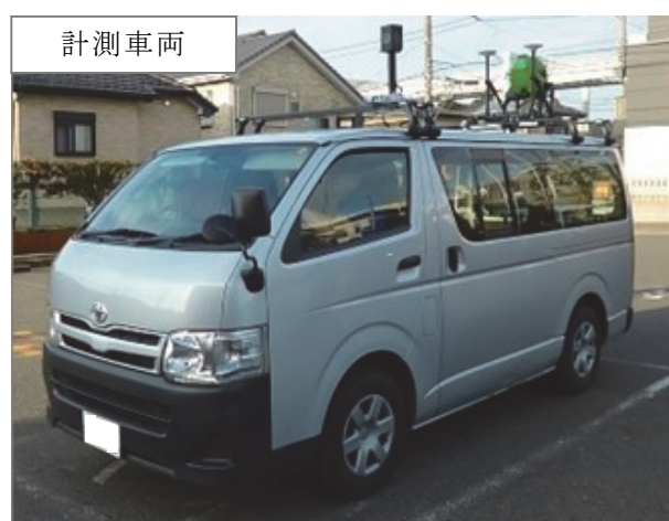
図-1 道路面上の主要地物の位置情報を走行車両から取得するイメージ
