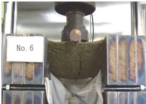
写真-1 最終時荷重載荷とひび割れ状況 (②供試体)
