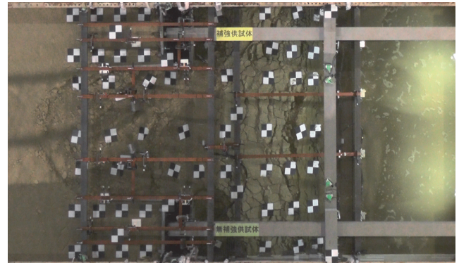
写真-2 加振後の地盤の残留変形
