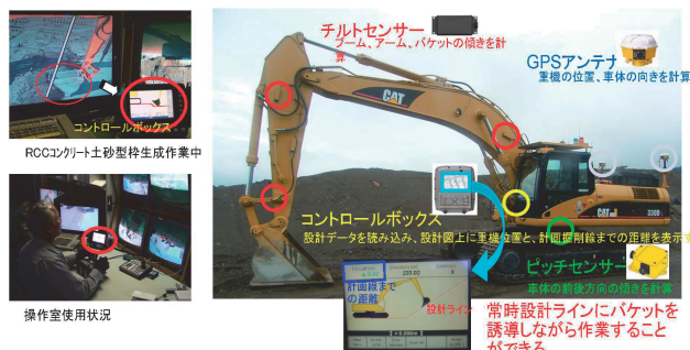
写真-7 3次元バックホウ誘導システム
