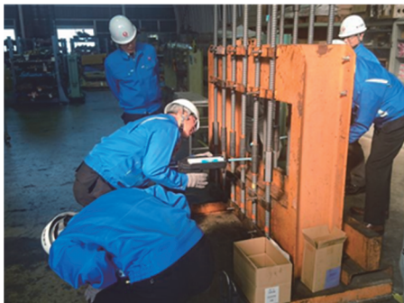
写真-2 施工性の確認試験の状況 (グラウト溢れ出しの確認)
