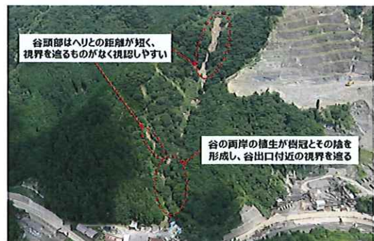
写真-3 土石流危険渓流の点検時における特徴
