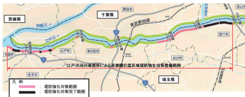
図-4 江戸川堤防強化対策区間
