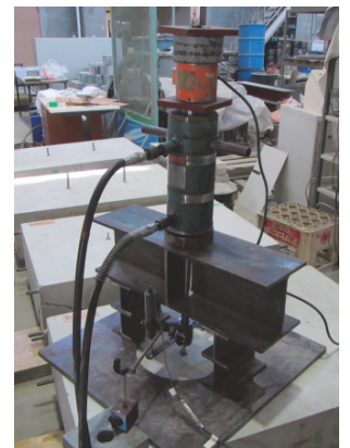
写真-1 アンカー引抜き試験の様子
