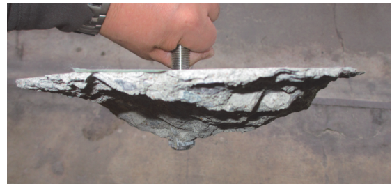
写真-2 引抜き試験後の状態の一例（ケース1の例）
