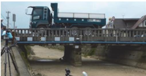
写真-3 車両走行試験状況
