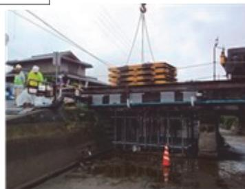
写真-4 静的載荷試験状況
