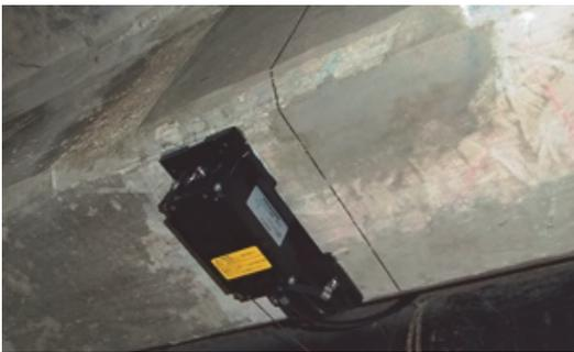
写真-6 加速度・傾斜センサの外観
