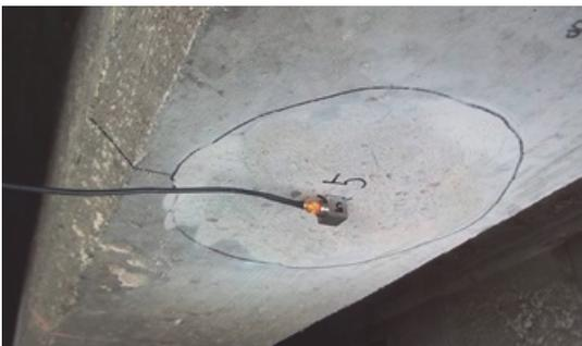
写真-7 加速度センサ外観
