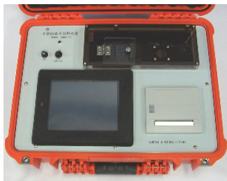
図-7 貫入式間隙水圧計 (4m)
