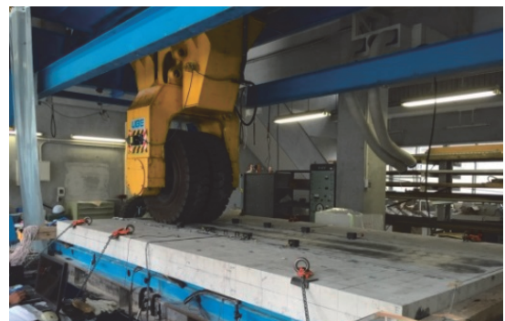
図-4 輪荷重走行試験状況
