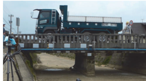
図-9 現場走行試験状況
